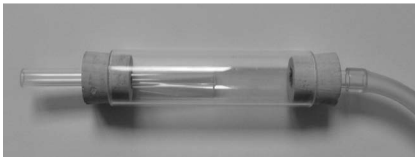
Obr. 5: Exhaustor. Drobní bezobratlí jsou nasáváni tenkou skleněnou trubičkou (vlevo) do zásobníku mezi dvěma zátkami.
