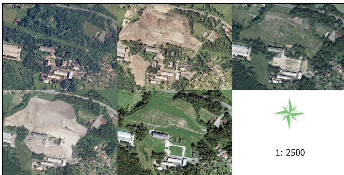
Obrázek 5: Vývoj vegetačního pokryvu v areálu bývalého Dolu Václav během posledních deseti let v závislosti na prováděných sanacích území. Snímky jsou řazeny chronologicky zleva doprava a shora dolů a jsou pořizeny v letech 2006, 2009, 2012, 2014 a 2016 (zdroj: ČÚZK, © 2017; upraveno autorem).
