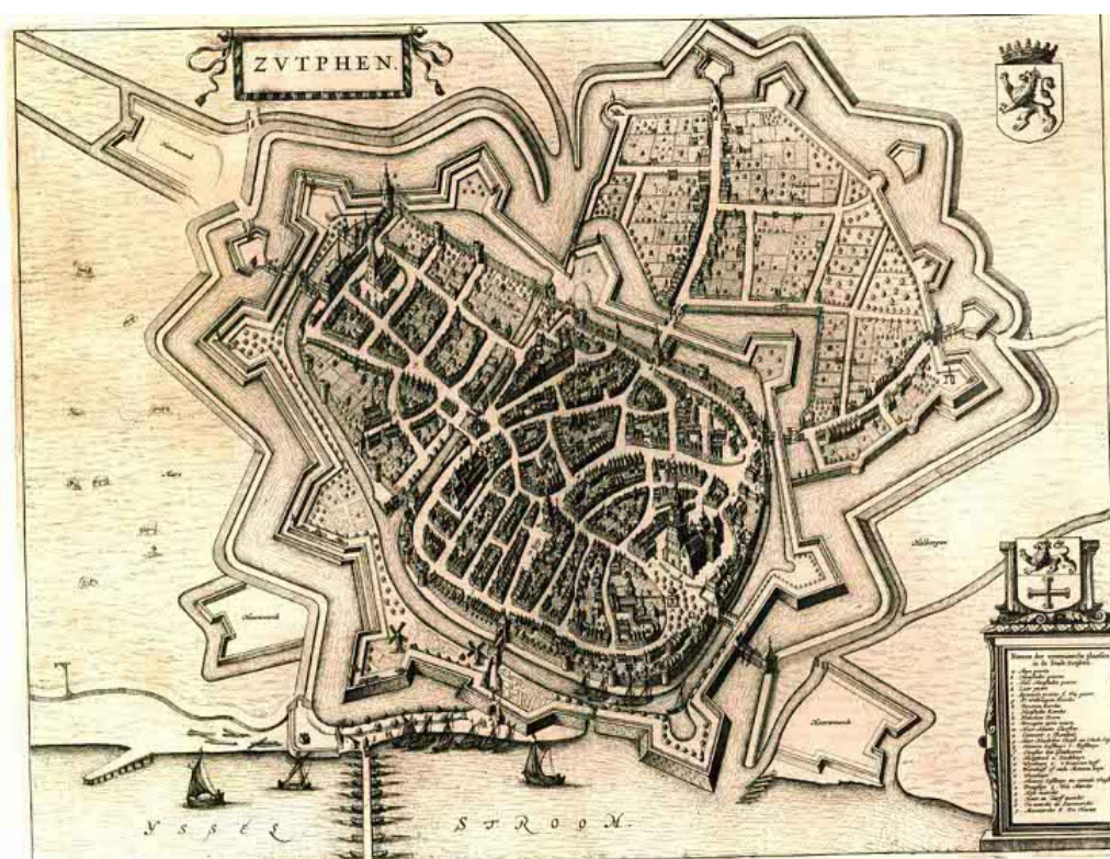
Nahoře : holandská pevnost Coevorden, na které je zřetelně vidět dvojitě uspořádaní čistě zemních valů a předsunuté taveliny v příkopu a půlměsíce před špičkami bastionů. Krigsarkivet: 0406:14:040:005 1605 Koevorden Plan der fortification von Coewerden. Dole : holandská pevnost Zutphen, ukázka typického defenzivního využití vodních ploch. Krigsarkivet: 0406:14:074:001.
