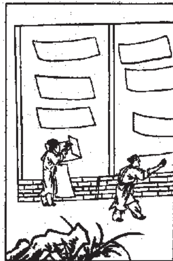
Výroba papíru na vyobrazení z knih o hospodářství ze 17. století: a) osekávání a máčení suroviny ve vodě; b) vaření papírové hmoty; c) nabírání papíroviny na síto; d) štosování mokrého papíru; e).sušení papíru na stěnách speciální pece; f) snímání suchých archů papíru. (SUNG Jing-sing, s. 220–225)
