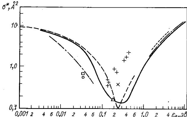
Рис. 5.9. Диффузионное сечение столкновения электрона с атомом аргона.
