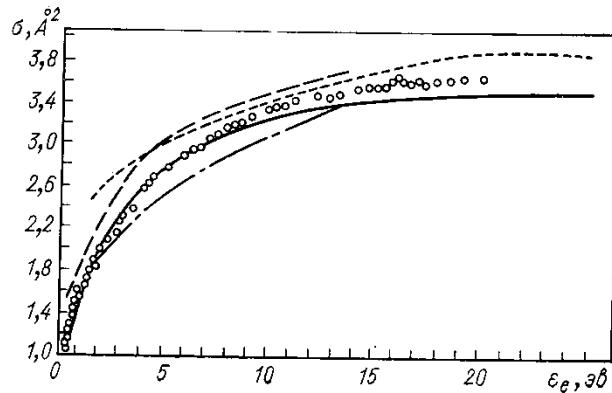
Рис. 5.8. Полное сечение рассеяния электрона на атоме неона.
