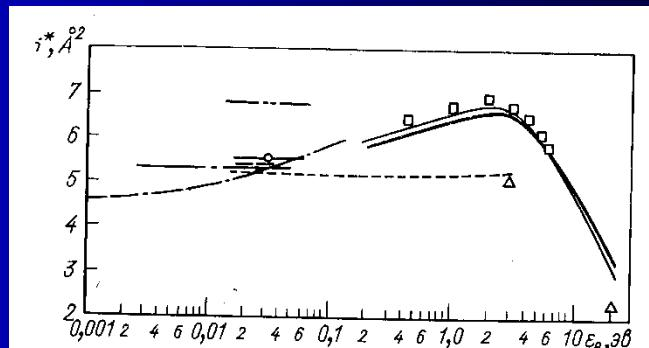
Рис. 5.3. Диффузионное сечение столкновения электрона с атомом гелия.
