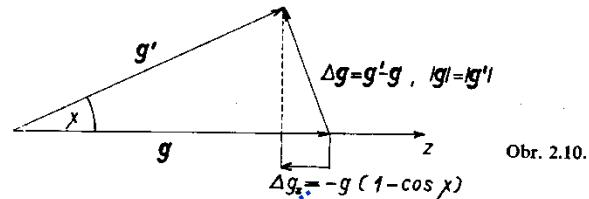
Změnu relativní rychlosti jedné částice svazku  $\Delta g_z$  určíme snadno z obr. 2.10. Snadno zjistíme, že
