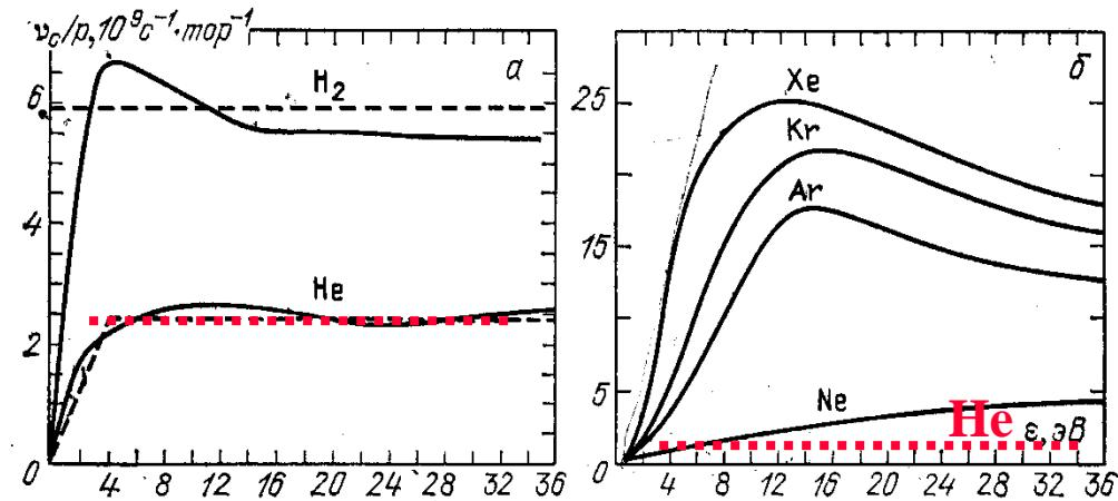
Рис. 2.5. Частоты упругих столкновений электронов,  $p=1$  тор: а — в  $\text{H}_2$  и  $\text{He}$ ; б — в инертных газах; штриховые линии — удобная аппроксимация при расчетах [24]
