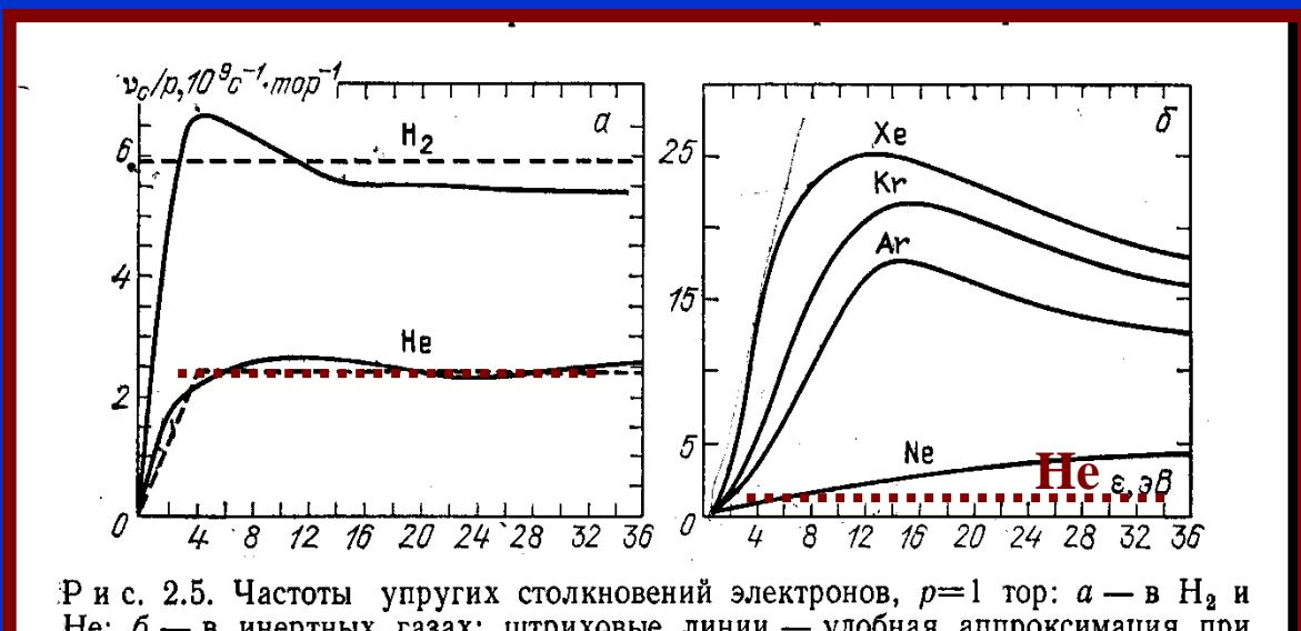
Рис. 2.5. Частоты упругих столкновений электронов,  $p=1$  топ: а — в  $H_2$  и  $He$ ; б — в инертных газах; штриховые линии — удобная аппроксимация при расчетах [24]
