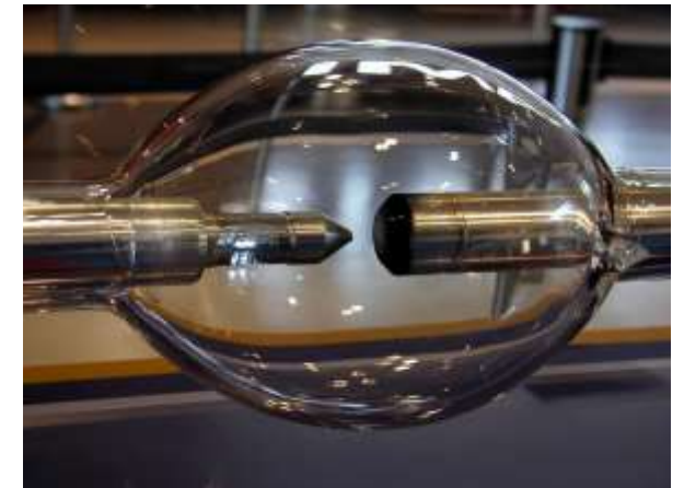
IMAX 15 kW Xe lamp, 25 bar
