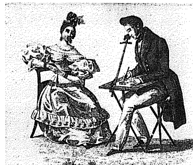
Obrázek 2.4 Camera lucida se skládala z uspořádání čoček, které umělci umožnilo vidět objekt a kreslicí papír ve stejném „rámu“ a tak prostě obkreslit obraz, který vypadal jako promítaný na papír (International Museum of Photography, George Eastman House).
