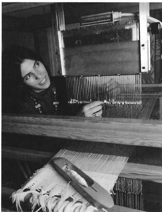
Současný ruční stav, v popředí člunek s navinutou útkovou nití Převzato z Textileforum 1/1994.
