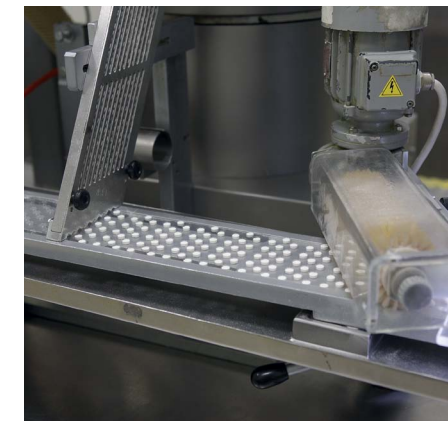
vtlačování tablet do blistrů
