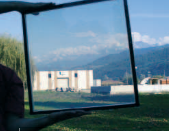
Aerogelem naplněné dvojité zasklení zabraňuje tepelným ztrátám.
