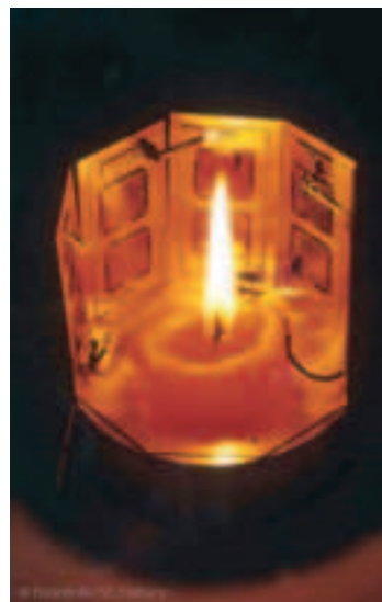
Světlo svíčky postačí termofotovoltaickým článkům k napájení rádia.
