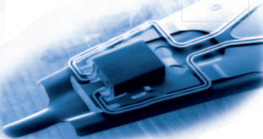
Nové efekty pro výkonné pevné disky: snímání hlava využívá obrovský magnetický odpor pomocí polovodičového prvku z více než dvaceti nanovrstev.
