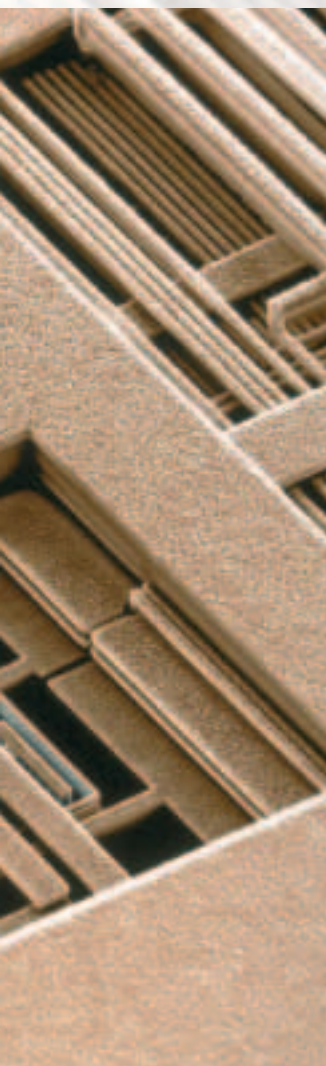
Složité jako miniatura města – leptané měděné spoje čipu (IBM), vyobrazeno pomocí rastrovacího elektronového mikroskopu. Moderní čipy mají až devět úrovní zapojení.
