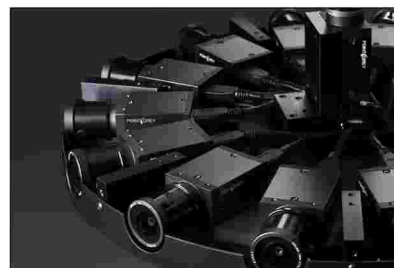
soustava kamer pro snímání 360° obrazu
